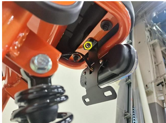
Irrota istuimen kiinnitysmutteri (kiintoavain 10 mm).
