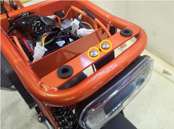
Irrota takavalon pidikkeen kiinnityspultit (Kuusiokoloavain 5 mm).
