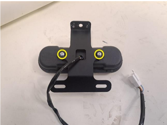
Irrota takavalon kiinnitysruuvit (ristipäämeisseli ph2).
